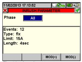
Fig. 127: Inrush currents parameters
